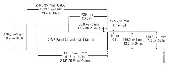
2-M /E ControlPanelCutoutD im ensions, Curved Installation
