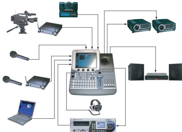
Изображение 7. Подключения для настройки большого события
