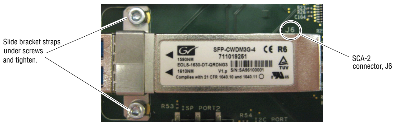
Figure 8. Install F1 and F2 SFP Devices
