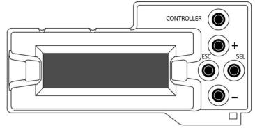
Figure 4.1 Densité Frame local control panel
