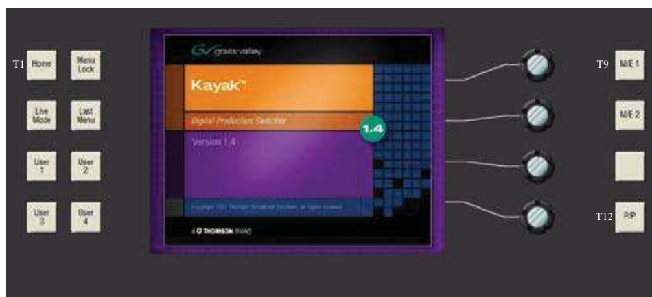
Рисунок 79. перезагрузка CPU панели — клавиши T1, T9, T12
