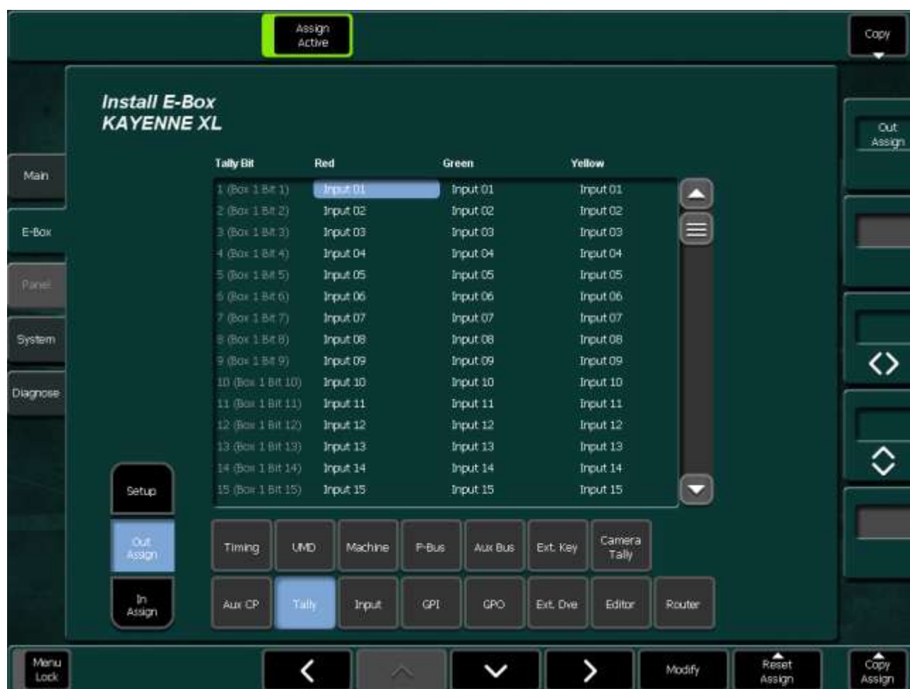
Рисунок 351. Установка назначения выхода индикаторов E-Box
