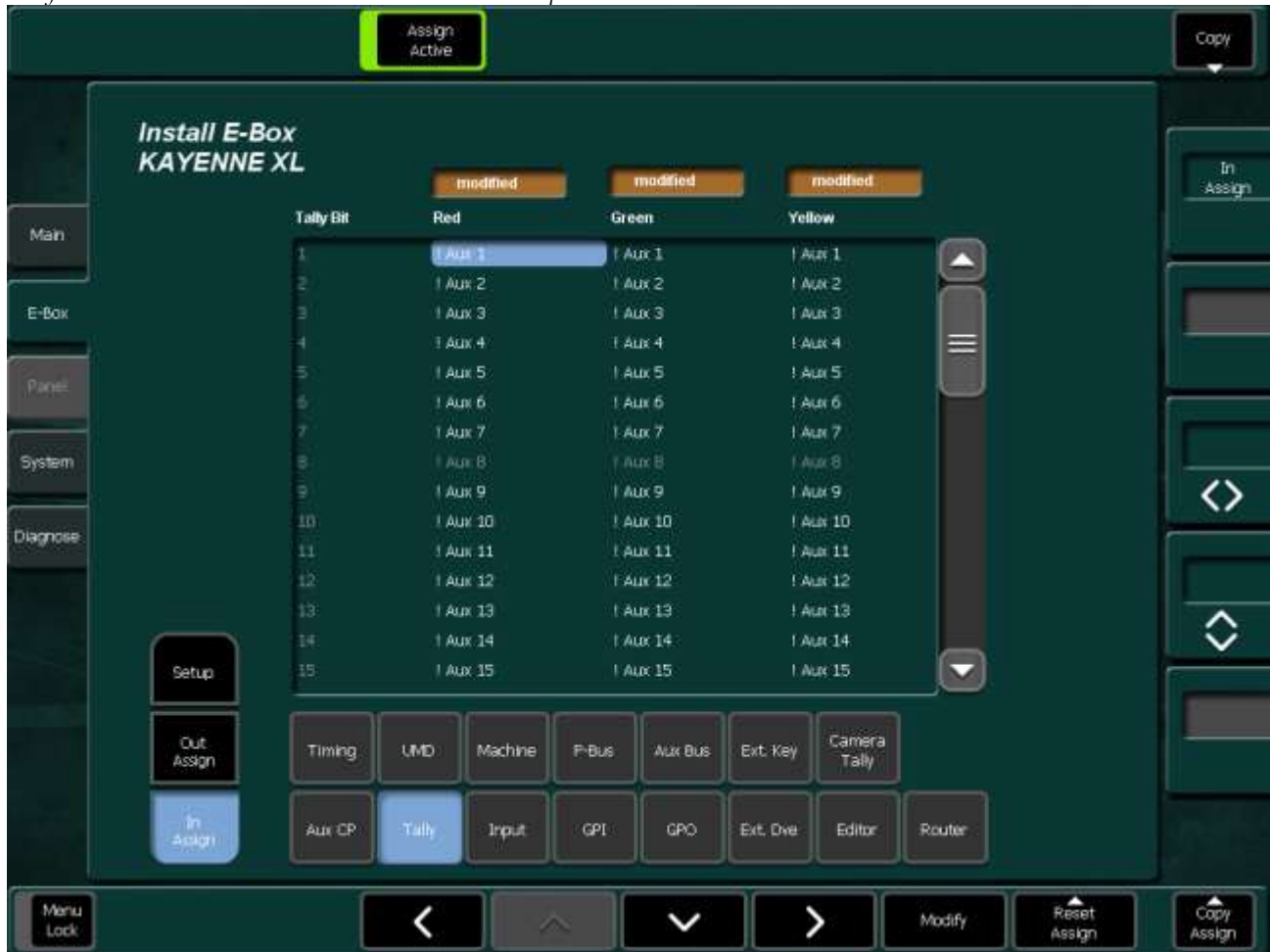
Рисунок 354. Установка назначения входа индикаторов E-Box
